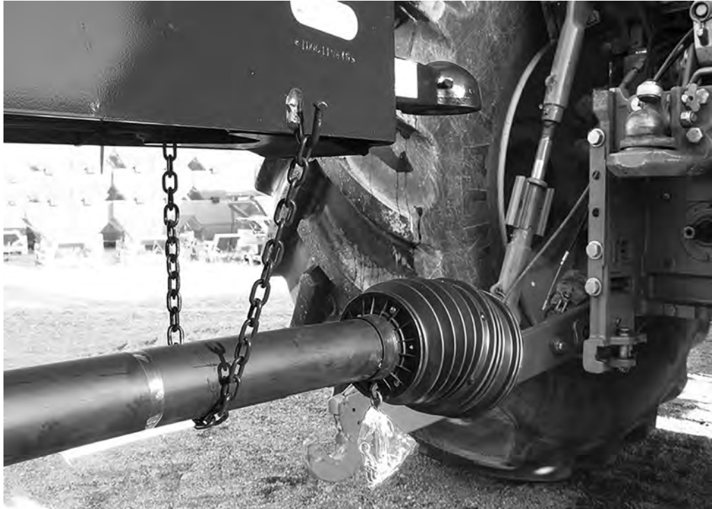
Bild 6.6: Lägga ner kraftöverföringsaxeln
